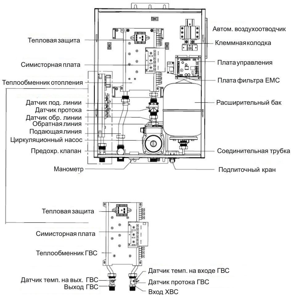
Рис. 2. Схема внутреннего устройства изделия
